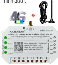
**Bước 2:** Lắp anten vào với công tắc, và duỗi thẳng dây kéo dài.
